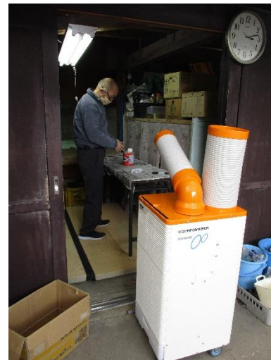
スポットエアコンを設置することで 施設外倉庫でも作業も可能となった。
